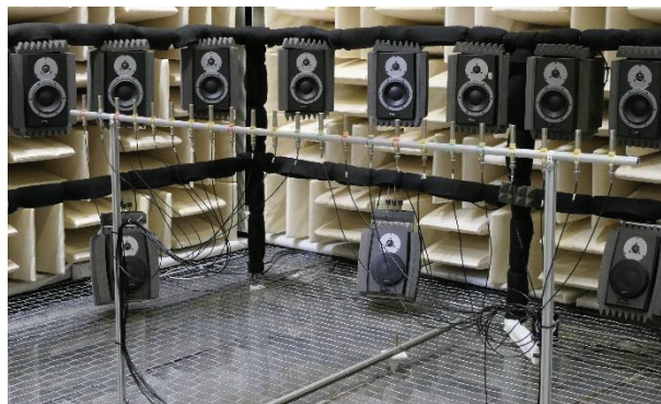
Abbildung 1: Fahrbares Mikrofonarray mit 23 Halb Zoll-Messmikrofonen in einem Abstand von 8.5 cm. Dahinter ist ein Teil des Lautsprecherarrays zu sehen.
