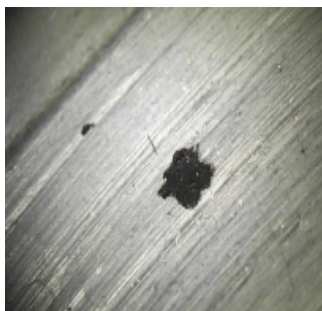
Abbildung 1: Dies ist ein Aluminiumdruckgussteil mit einem Defekt-Einschluss (dunkel).
