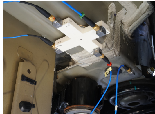
Abbildung 3: Messaufbau mit Hilfsstruktur
