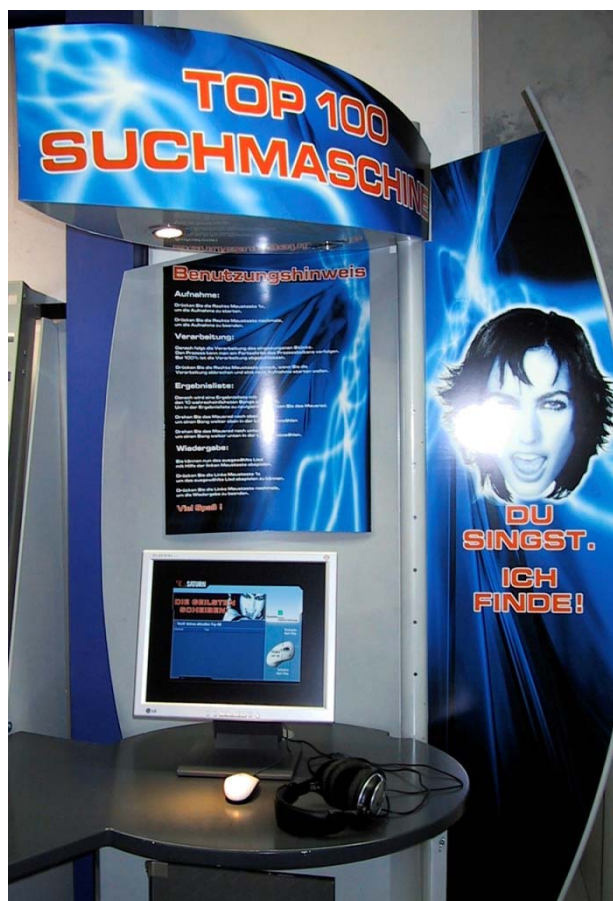
Bild 4: Prototyp einer Musikererkennungshardware für den Einsatz in einem Musikgeschäft (Bildquelle: Fraunhofer IDMT)
