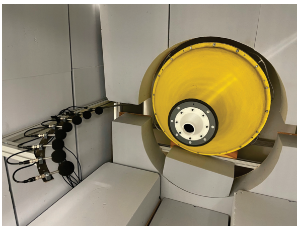
Abbildung 6: Foto des Messaufbaus mit den Messmikrofonen
