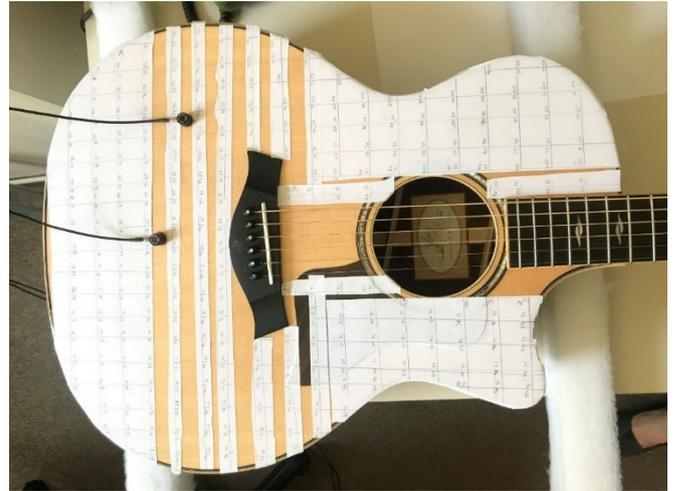
**Abbildung 6:** Raster für die experimentelle Modalanalyse mittels Roving-Hammer bei fester Position der Beschleunigungsaufnehmer.
