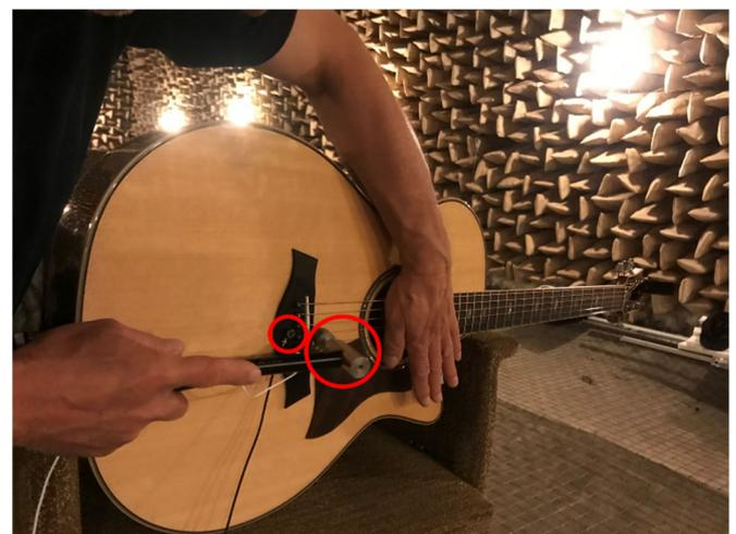
**Abbildung 4:** Anschlag des Stegs mit einem Impulshammer.
