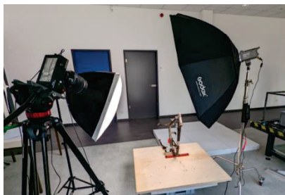
Abbildung 5, Ausleuchtung für die Messungen des optischen Flusses
