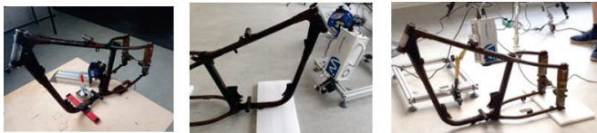
Abbildung 4, freie Rahmenaushängung, Anregung durch Impulshammer
