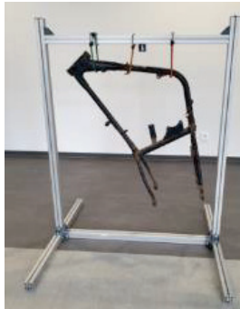
Abbildung 3 freie Rahmenaushängung, Anregung durch Impulshammer
