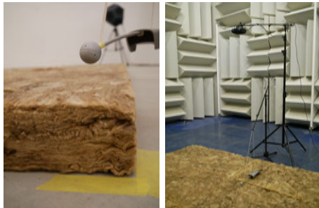
Abbildung 5: Poröser Absorber: Messungen mit der SonoCat im Hallraum (rechts) und im Halbfreifeldraum (links).
