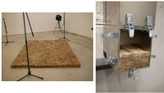
Abbildung 4: Poröser Absorber: Messungen im Hallraum nach DIN EN ISO 354 (rechts) und Kundtschen Rohr nach DIN EN ISO 10534-2 (links).
