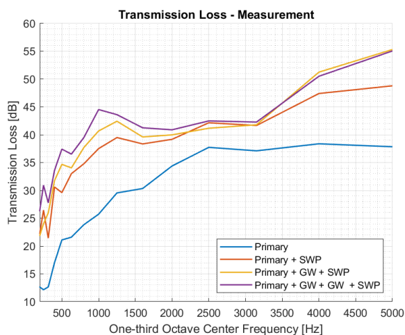
Abbildung 5: TL der Seitenwandkonfigurationen basierend auf den Messergebnissen
