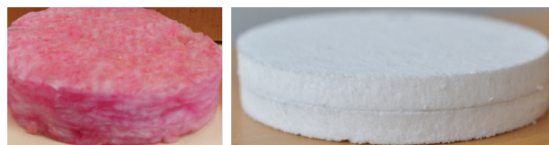
Abbildung 4: Verwendete Dämmmaterialien. Glaswolle (links) und Aerogel (rechts).
